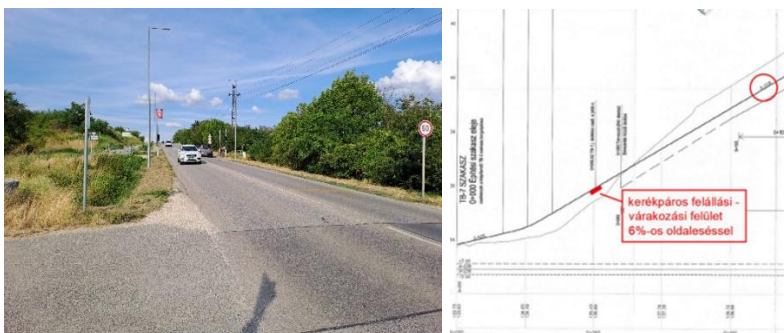
9. ábra: 81101. j. utat keresztező Budapest-Balaton kerékpárút jelzőlámpás szabályozással, a turisztikai célú kerékpárút nyomvonalán, lejtőben kialakítva [7]
