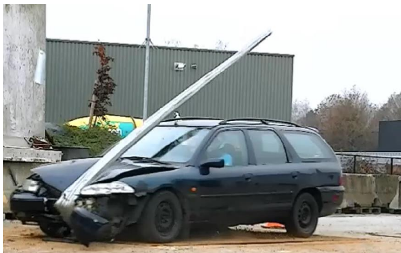
2. ábra: Pillanatfelvétel a HE osztályú, nagy energiaelnyelő-képességű oszlopok ütközési tesztje közben
