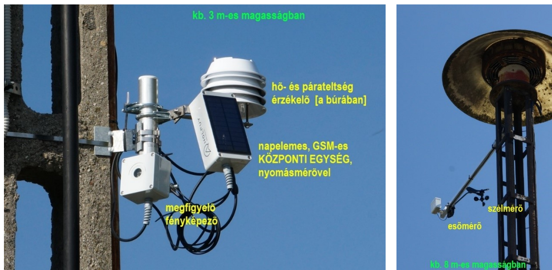
8. ábra: napelemes és GSM-adatközlésű időjárási kisállomás, légoltalmi szirénaoszlopra szerelve - a szél- és az esőmérő eltartására csak a hangkupola árnyékolása miatt volt szükség (a szerző felvétele ill. telepítése, 2018-ból)
