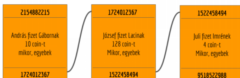
1. ábra: A blokklánc működésének alapelve (forrás: kriptolio.hu)
