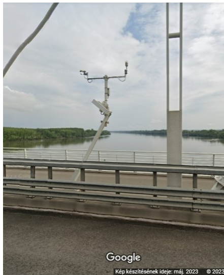
7. ábra: útidőjárási műszer-együttes a Megyeri-hídon (eredetileg a hajózás számára): a keresztkar bal szárán a látástávolság-érzékelő, a jobbon pedig az alapelemeknek egy egyesített mérőfeje (forrás: GoogleMaps, StreetView)
