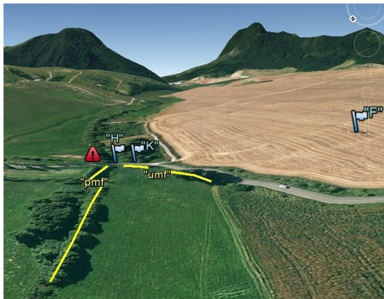
5. ábra: helyi szélcsatorna felderítése egy patak völgy talpában (H, K és F szélmérési pontok), párhuzamos és megszakadó árnyékoló fasoroknál – ami egy veszélyes útkanyarulatra fúj keresztbe ( a szerző munkája bírósági szakvéleményhez, GoogleEarth-ben - a domborzat kiemelése 3x-os! )
