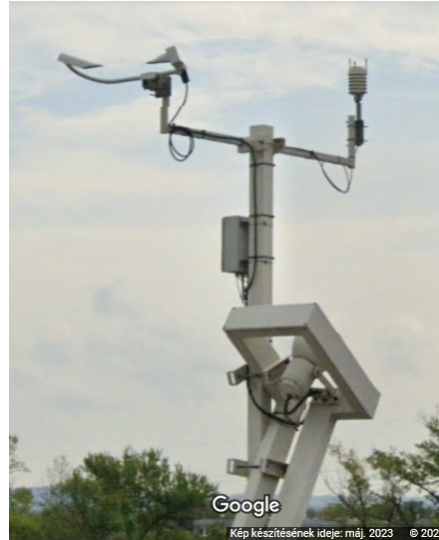
7. ábra: útidőjárási műszer-együttes a Megyeri-hídon (eredetileg a hajózás számára): a keresztkar bal szárán a látástávolság-érzékelő, a jobbon pedig az alapelemeknek egy egyesített mérőfeje (forrás: GoogleMaps, StreetView)
