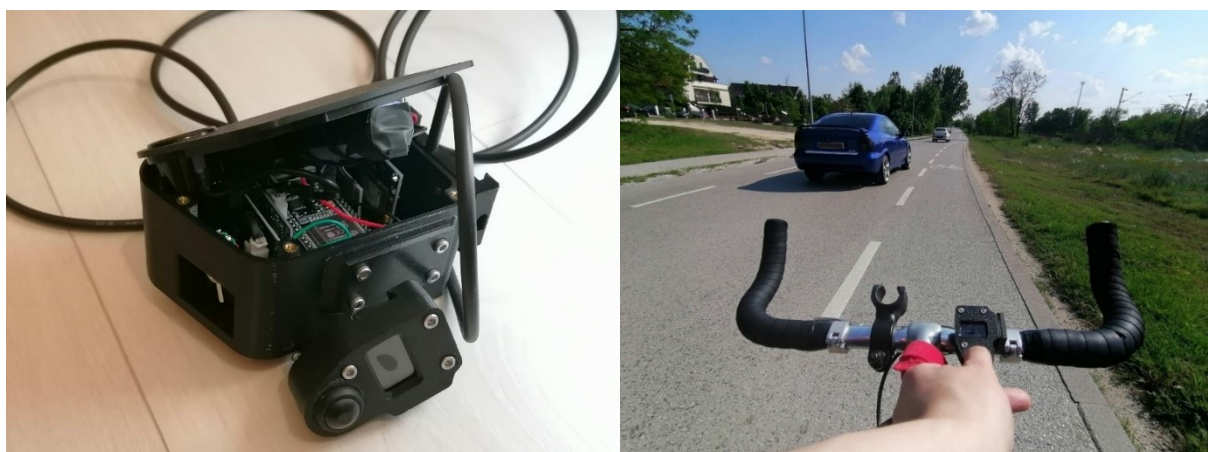
26. ábra: A mérésekhez használt OpenBikeSensor. Balra: elöl a vezérlőelem látható, a háttérben a szenzor. Jobbra: a műszer kerékpárra szerelve, mérés közben
